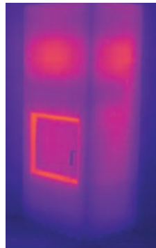
8 Std. nach dem Anheizen Durchschnittliche Oberflächentemperatur 46 °C
